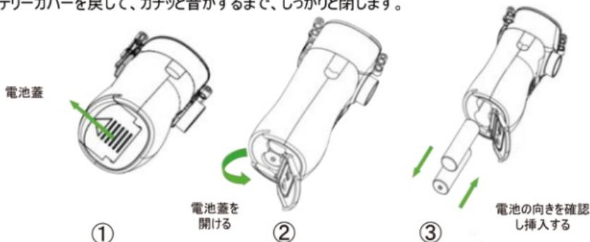
図3(乾電池の取り付け)
